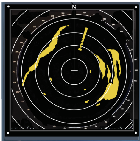
Bild 3.3.3.2 Presentation av Racon i navigationsradar.
