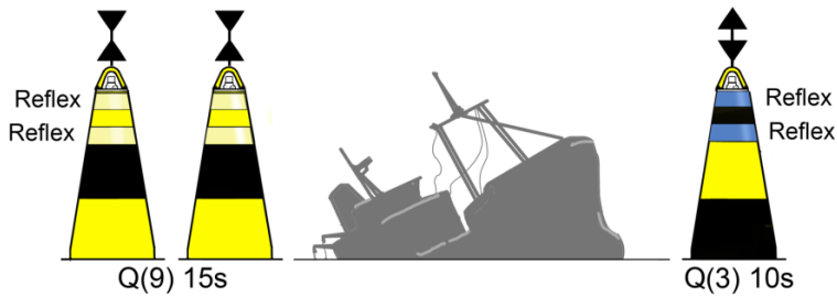
Bild 3.1.7.1 SSA av typ nytt hinder har till uppgift att markera ett uppkommet hinder (ex. vrak, rasmassor).
